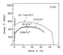
固体材料にはあまり知られていない「ひずみ速度効果」という性質があります。同じ材料でも変形させられるときの速度が変わると、抵抗する力の大きさが変わります。ゆっくりとした変形速度では材料の強度は低いままですが、急激にドカンと変形させようとする強度が2割も3割も上昇します。
