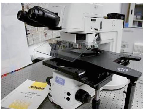
IC 検査光学顕微鏡 （薄膜評価実験に用いる装置）
