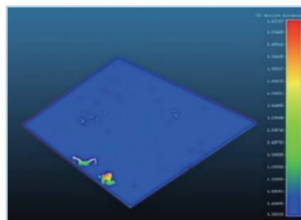
異なる時点の点群データを差分解析し、ずれる箇所を可視化する
