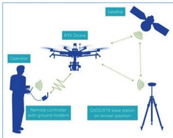
RTK-UAVレーザー測量を用いたリアルタイムで点群データを収集
