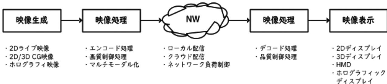
2次元（2D）・3次元（3D）の映像を対象として、映像を生成（撮影）する処理部、ネットワークを介して配信する処理部、映像を表示する処理部のハードウェア設計・ソフトウェア開発を行っています。また、システム全体を対象とした設計・開発を行っています。
