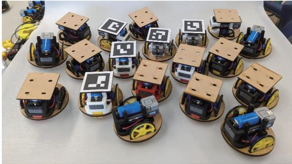
IoT群ロボット、画像認識による個体検出
