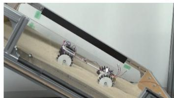
地盤のせん断力を利用した小型移動ロボットによる高斜度軟弱地盤（30度）における低スリップ走行
